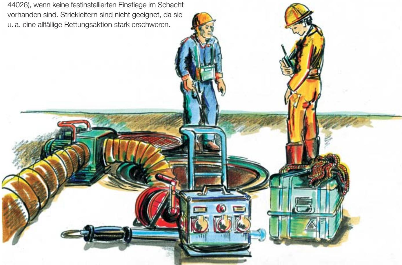
**Bild 2:** Schutzmaterial, das der Arbeitsgruppe zur Verfügung gestellt werden muss:
