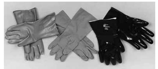
Bild 7: Bei der Wahl der Handschuhe ist darauf zu achten, dass sie für die jeweiligen Arbeitsstoffe undurchlässig sind.
