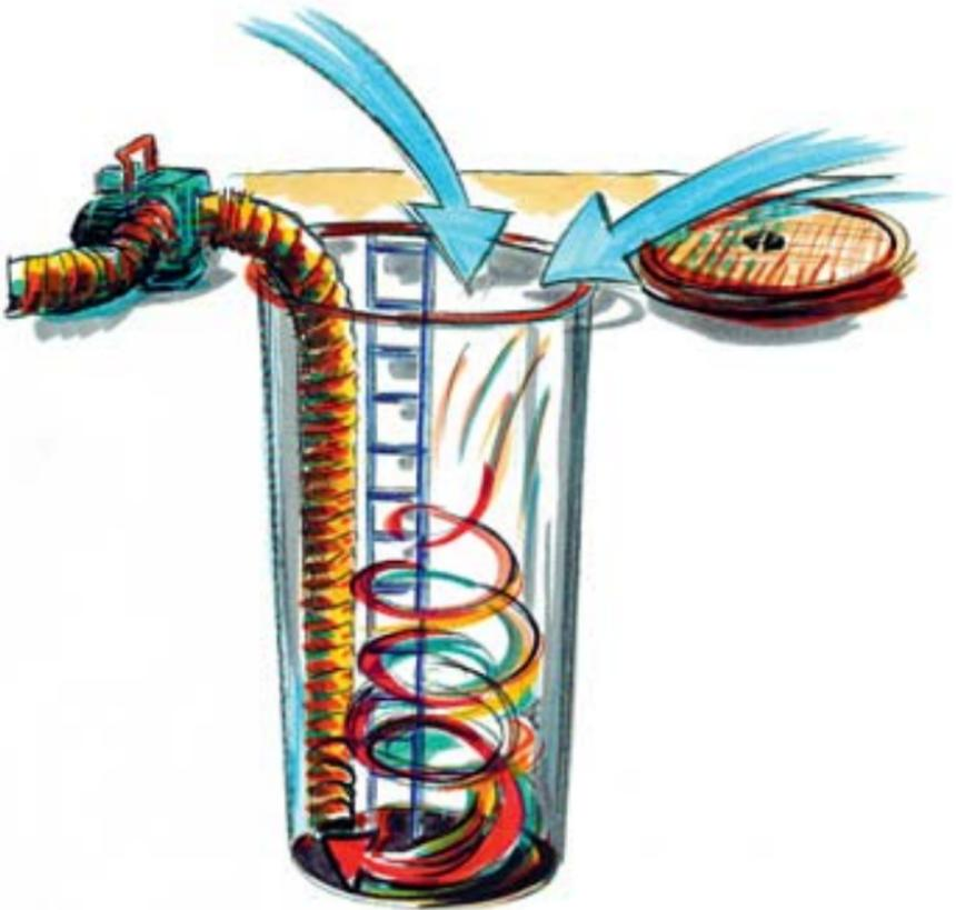
Saugen Sie vor dem Einsteigen gefährliche Gase und Dämpfe mit dem Ventilator ab.
