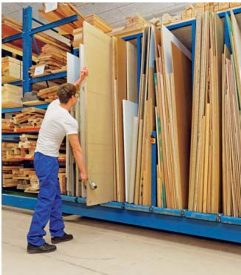
**Lavoratore:** durante la lavorazione, il montaggio, lo stoccaggio e il trasporto mi assicuro sempre che le lastre, i tubi, le lamiere o altri materiali ingombranti non possano spostarsi.
