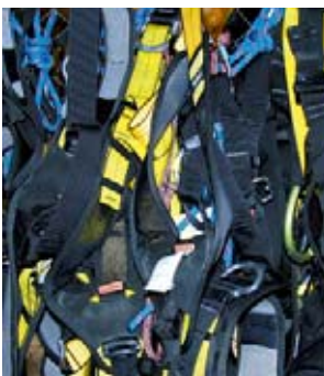
1 Was wurde wann, bei wem gekauft und letztmals geprüft? Dies muss nachgewiesen werden können.
