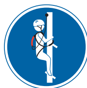
3 Positionierungssystem: Positioniert den Benutzer an der Arbeitsstelle. Ein freier Fall wird verhindert. Sehr geringes Verletzungsrisiko.
