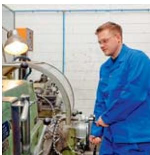
**1** Auch bei älteren Maschinen Schutzeinrichtung verwenden.
